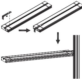
Weitere Montagearten möglich dank integrierter Nut-Profile (passend für viele Profilsysteme z.B. Bosch-Rexroth).
