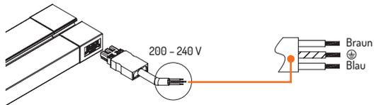
4 Verbinden Sie mehrere Leuchten mittels der vorgesehenen Verbindungsstücke. Diese sind nicht Teil des Lieferumfangs und separat erhältlich. Schalten Sie danach den Strom wieder ein.
