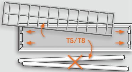
Für spannungsfreien Zustand an den Leuchtenklemmen sorgen. Den Rastereinsatz vom Bestandsgehäuse abziehen. Die alten T5- oder T8-Leuchtstoffröhren lösen und entsorgen.
